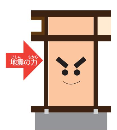
ちか てっきん 地下に鉄筋コンクリートの重石を設け、 重石と壁をつなぎ、浮き上がりを防ぐ
