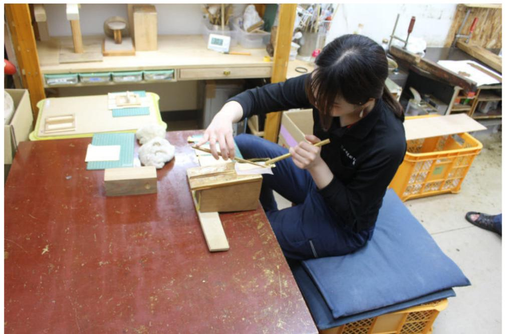
漆をノリ代わりに薄く塗り、金箔を貼り付ける「箔押し」作業
