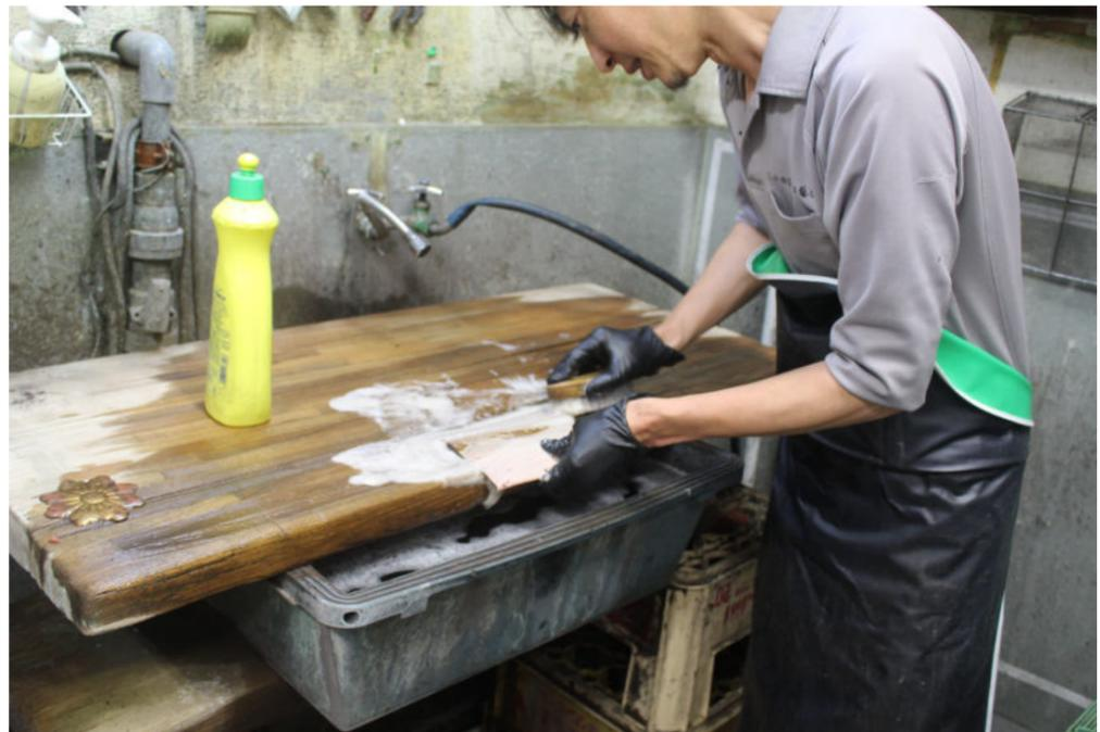
酸洗い後の洗浄作業。希硫酸を洗い流すので、手袋が必須。
