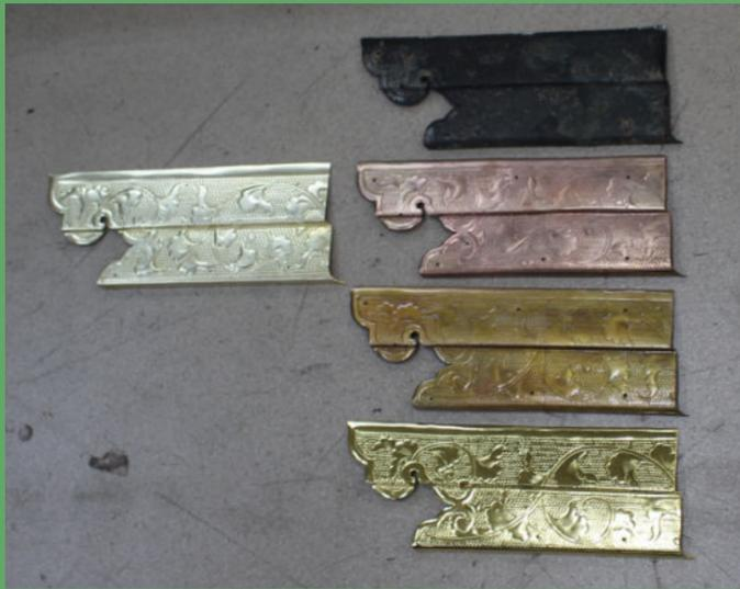
取り外し後。箔が落ち錆びている。
