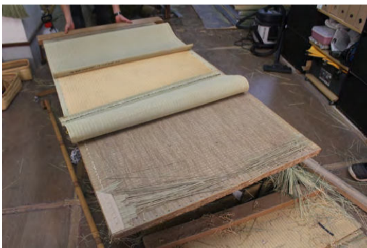
しんざい わら お かた つく わらどこ 芯材は藁をきつく押し固めて作った「藁床」。 かけぬ よ しゅほう つく こうきゅうひん 「掛縫い」と呼ばれる手法で作られた高級品。
