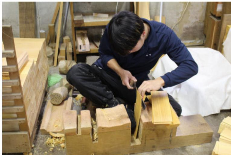
丸太をまず「みかん割り（六等分）」し、そこから厚板を切り出します。その厚板を手で割り裂いて二等分することを繰り返し、最終的に一分（＝約3mm）の薄い板＝柿板を作り出します。手割りのため板の表面は凸凹がありザラザラ、そのため屋根板として並べたときに板同士が密着しないという特性があります。
