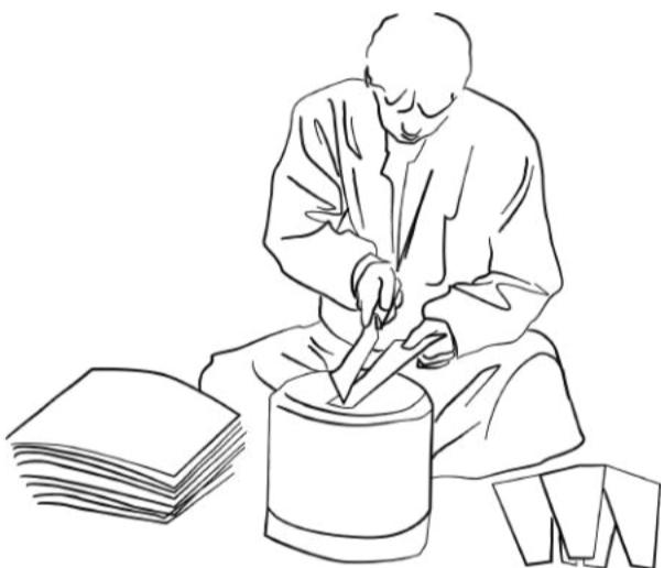
荒々しい自然のままの皮（＝生皮）が、職人の操る「庖丁」によってきれいに整えられ檜皮となり、出荷待ちの形で積み重ねられていきます。屋根の大きさ・サイズにより必要とされる檜皮の形や量は様々、要望に応じて適切な量の拵えを行います。全国各地の文化財の現場は、このような縁の下の力持ちに支えられているのです。室内作業なので現場のような暑さや寒さ・天候に振り回される負担はないものの、座ったまま続ける仕事で、地道な作業のため若い後継者が育ちにくいというのが悩みどころだそう。
